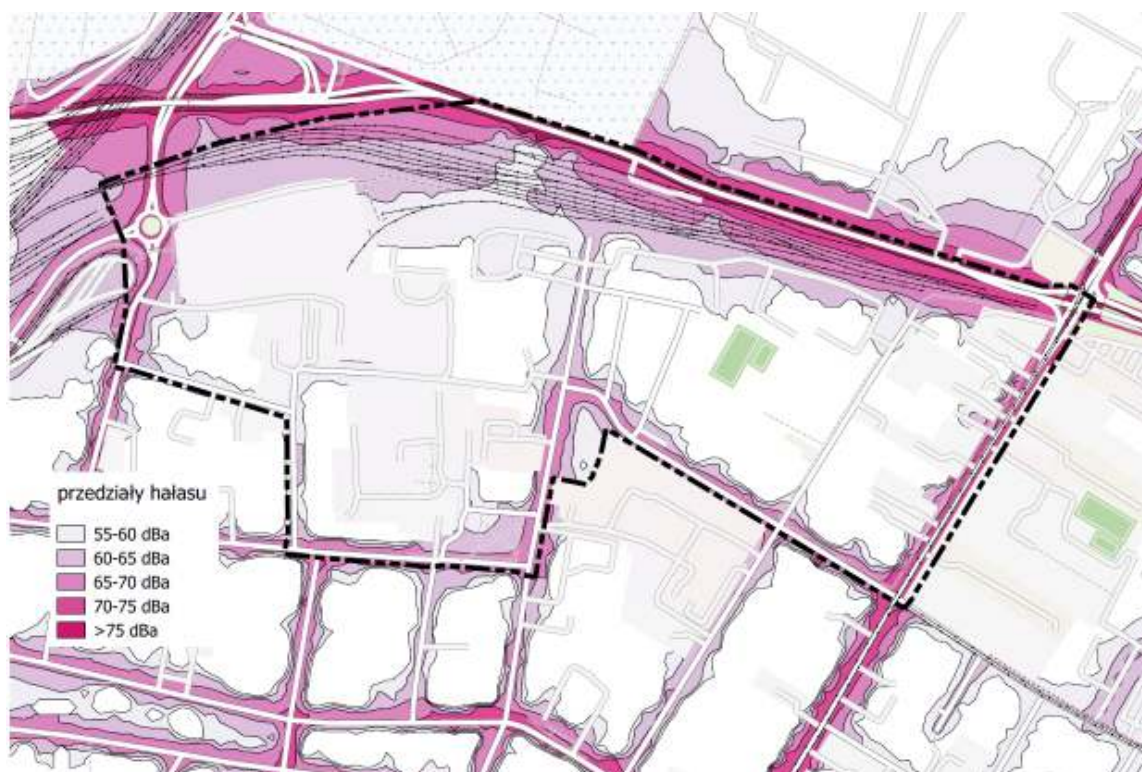
Ryc. Poziom hałasu drogowego mierzony wskaźnikiem I DWN
