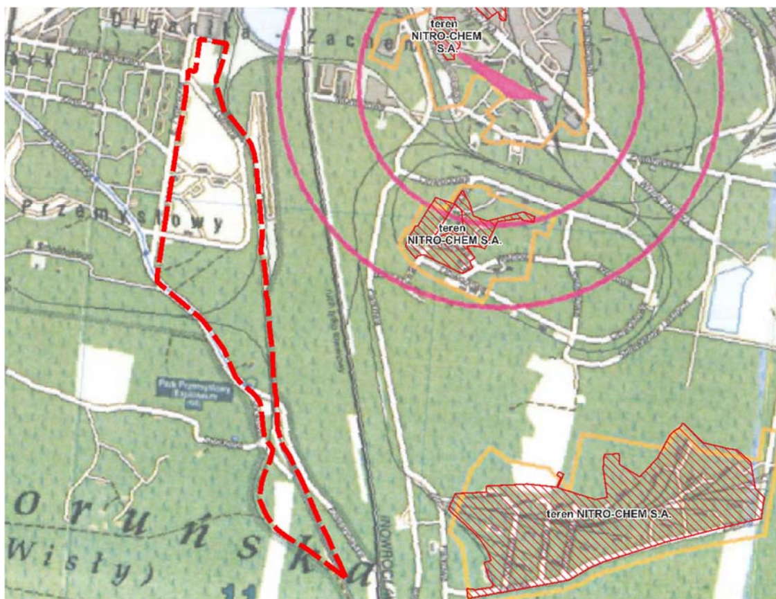
Ryc. Zasięg chmury oleum o stężeniu 10\text{mg/m}^3 , po wystąpieniu nieszczelności rurociągu przesyłowego oleum Dn 80, przy powierzchni wypływu równa 0,1 powierzchni przekroju poprzecznego rurociągu
