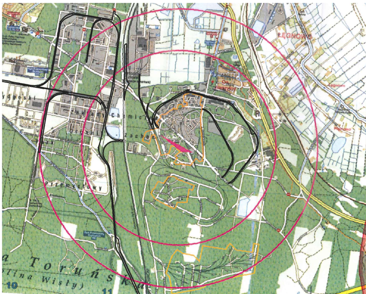
Ryc. Zasięg chmury oleum o stężeniu 10mg/m 3 , po zerwaniu rurociągu przesyłowego oleum Dn 80
