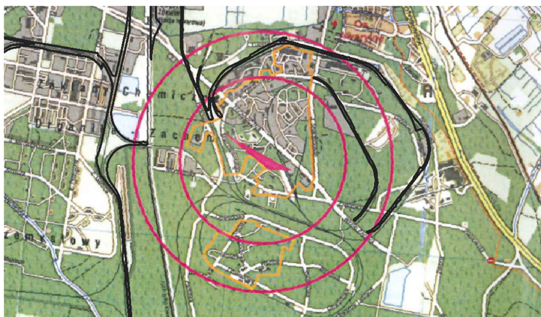
Ryc. Zasięg chmury oleum o stężeniu 10\text{mg}/\text{m}^3 , po wystąpieniu nieszczelności rurociągu przesyłowego oleum Dn 80, przy powierzchni wypływu równej 0,1 powierzchni przekroju poprzecznego rurociągu
