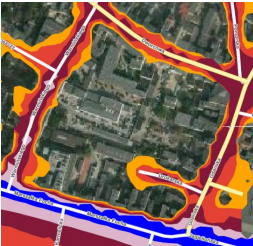
Ryc. Poziom hałasu drogowego mierzony wskaźnikiem I DWN
